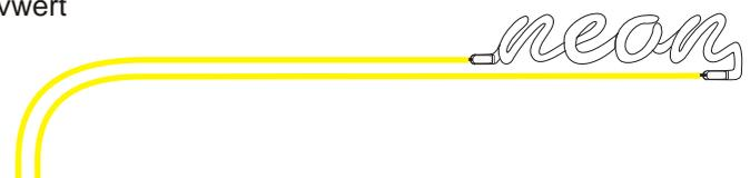
lange Neonkabel erzeugen erhebliche Stromspitzen, die zur vorzeitigen Alterung oder Zerstörung der Elektroden führen kann.
